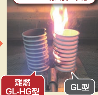
バーナー消火後の状態
