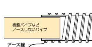
樹脂パイプ等の接続
