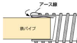
鉄パイプ等の接続
