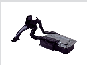
バッテリー冷却システム
